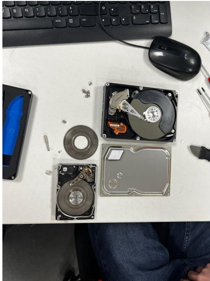
Fig. 5 — Vue d'ensemble des disques en cours de destruction (HDD 3,5" et 2,5", SSD)
