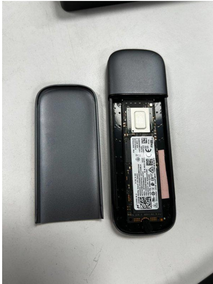
Fig. 10 — SSD NVMe M.2 (Micron 2300, 256 Go) extrait dans son boîtier USB
