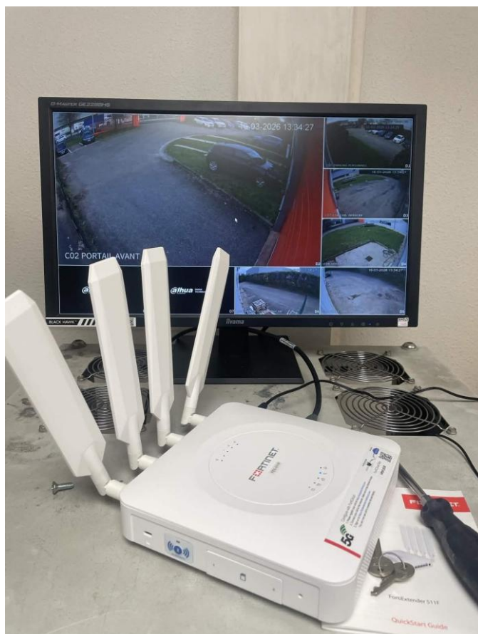
Photo 2 – FortiExtender 511F avec ses 4 antennes, écran vidéosurveillance Dahua en arrière-plan
